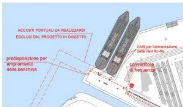
Figura 5.6 – Particolare planimetrico relativo al progetto di “cold ironing” del porto di Brindisi.
